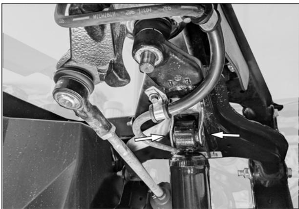
4. Retirer temporairement le boulon de fixation inférieur de l'amortisseur pour créer plus d'espace et faciliter l'installation de la plaque de renfort (E7-E8). Voir la Fig. 13
